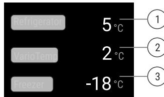
Fig. 7 The status display shows the actual temperature.
