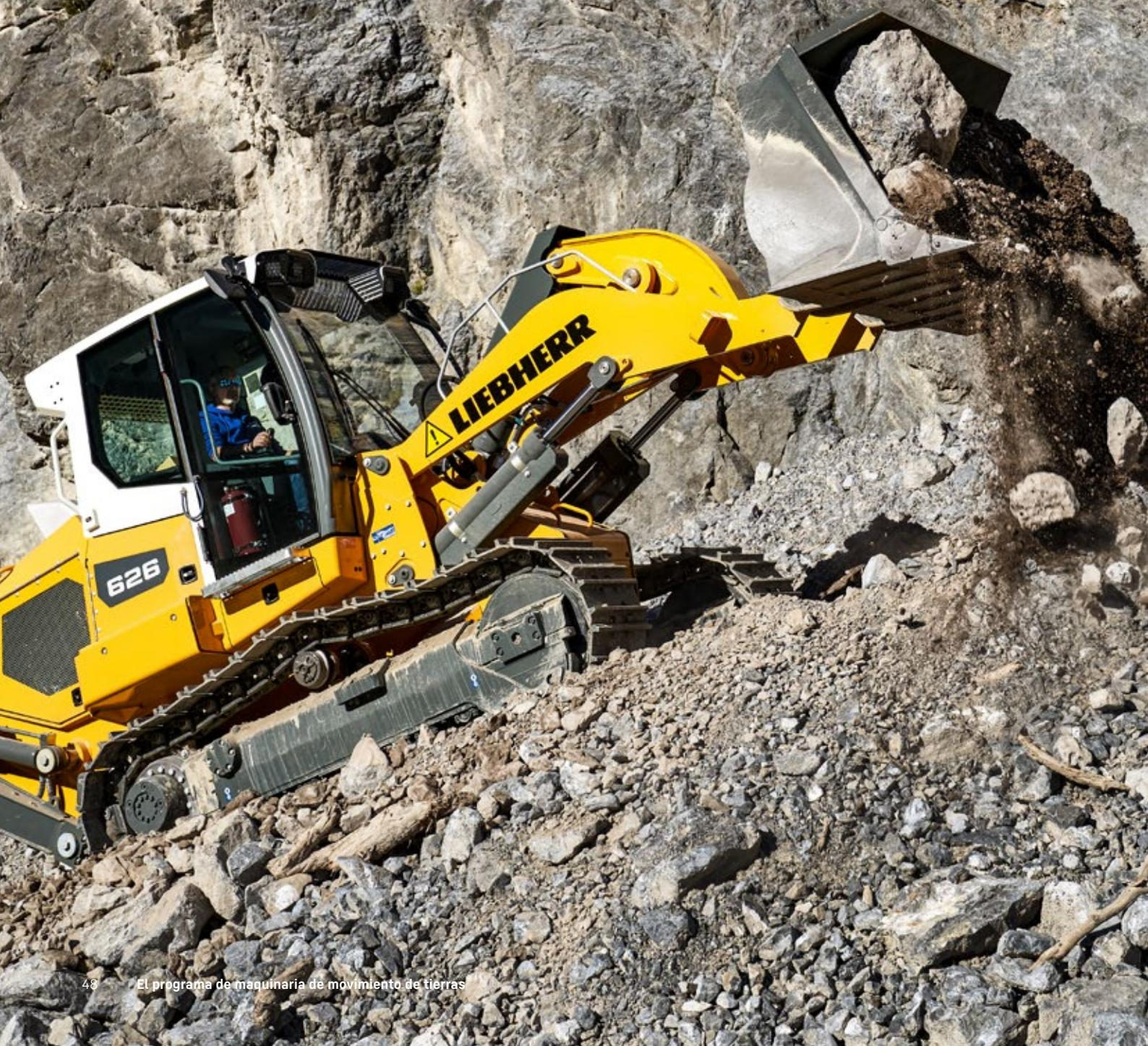
**Máxima tracción y fuerzas de arranque con una maniobrabilidad insuperable: Las palas cargadoras de cadenas Liebherr prestan su servicio en lugares inaccesibles para otras máquinas de obras públicas. Con un eficaz engranaje del mecanismo de traslación hidrostático y sistemas inteligentes de asistencia al conductor, se integran a la perfección en las modernas obras de movimiento de tierras.**
