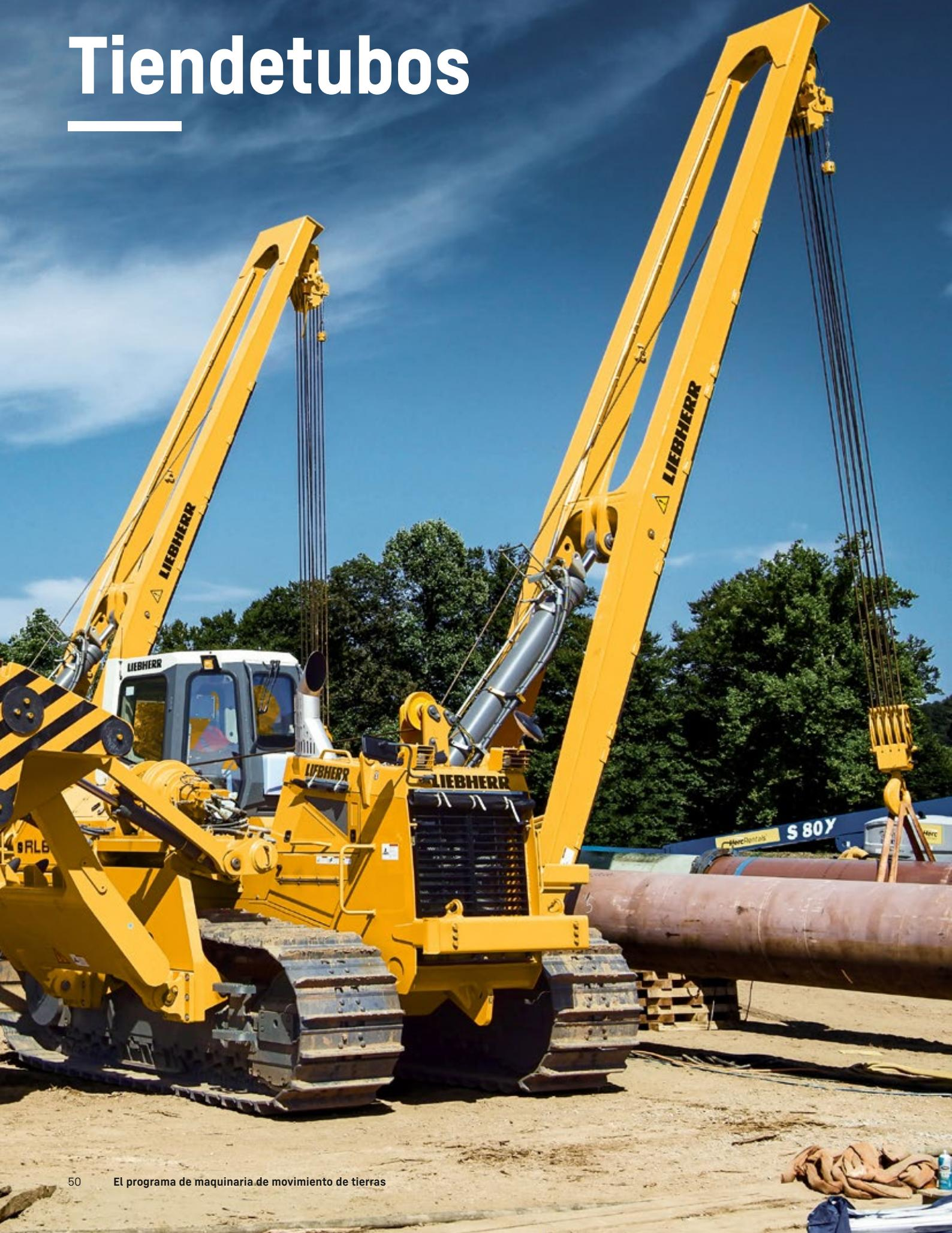
Tanto si se instalan tubos en pendientes como en terrenos blandos: La alta capacidad de elevación, la transmisión hidrostática continua, los elementos hidráulicos de trabajo controlables con precisión y las funciones de seguridad inteligentes permiten obtener la máxima productividad y seguridad en la obra.
