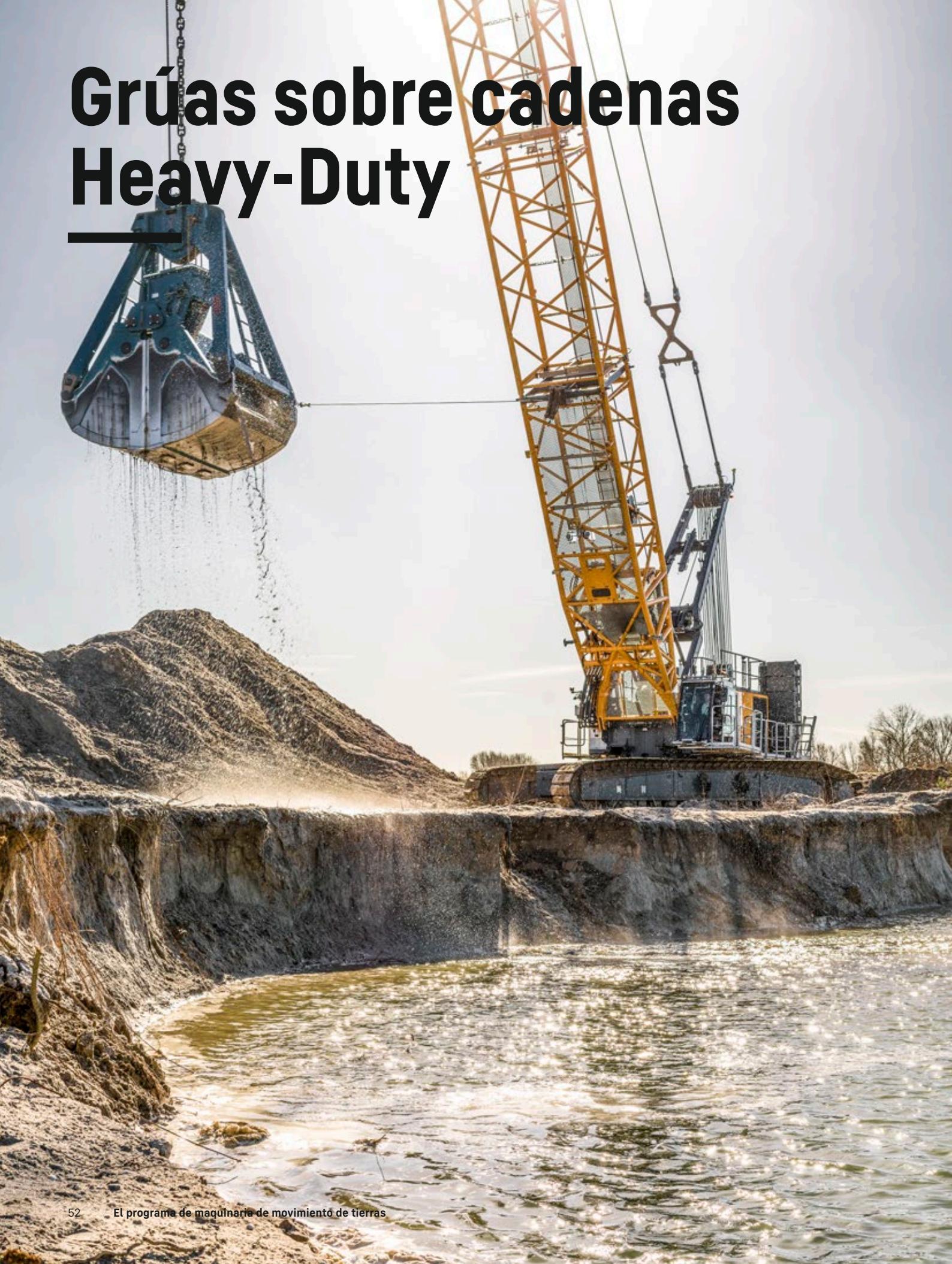
Además de la manipulación de materiales, la extracción de grava y el reciclaje, las grúas sobre cadenas Heavy-Duty de Liebherr se utilizan, sobre todo, en las cimentaciones especiales. La gama de tipos incluye unidades de todas las clases de potencia, desde 40 toneladas hasta 300 toneladas. Estas máquinas de eficacia probada se caracterizan por su flexibilidad, rentabilidad y excelente rendimiento.
