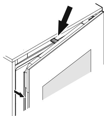
Die Tür wird durch die Schubstange ca. 7 cm geöffnet.
