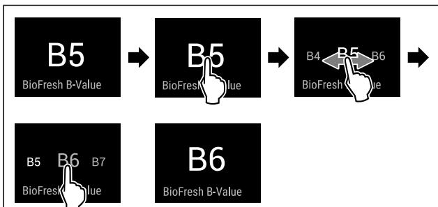
Fig. 26 Beispielhafte Darstellung: Von B5 zu B6 wechseln.
