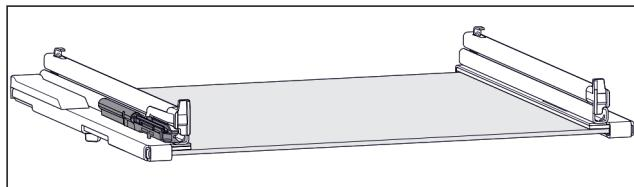
Fig. 100 Dämpfungseinheit
