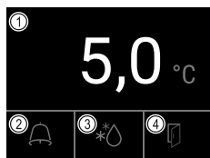
Fig. 69 Statusanzeige (1) Ist-Temperatur (2) Alarmstatus (3) Status Abtauvorgang (4) Status Türöffnung
