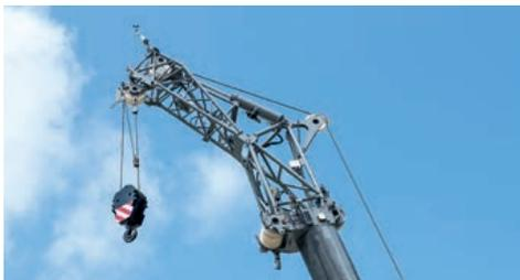
Falcone a regolazione idraulica (da 0° a 40°)
