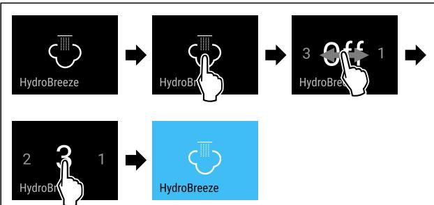
Fig. 65 Beispielhafte Darstellung: HydroBreeze mit Wert 3 aktivieren.
