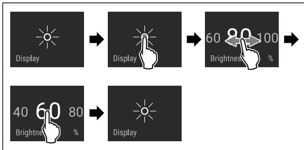
Fig. 87 Beispielhafte Darstellung: Von 80 % zu 60 % wechseln.
