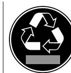
Dieses oder ein ähnliches Symbol kann sich auf der Rückseite des Geräts befinden. Es verweist darauf, dass sich in der Tür und/oder im Gehäuse Vakuumisolierpaneel (VIP) oder Perlitepaneel befinden. Dieser Hinweis ist nur für das Recycling bedeutsam. Dieses Symbol nicht entfernen.
