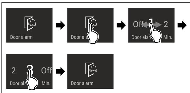
Fig. 89 Beispielhafte Darstellung: Türalarm von 1 Minute zu 3 Minuten wechseln.
