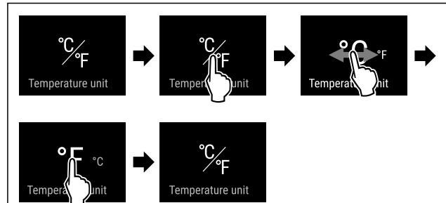
Fig. 28 Beispielhafte Darstellung: Von Grad Celsius zu Grad Fahrenheit wechseln.
