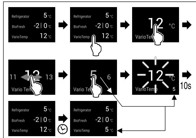
Fig. 39 Beispielhafte Darstellung: VarioTemp von 12 °C auf 5 °C für eine Kühl-Gefrier-Kombination mit Fish & Seafood-Safe ändern.\*
