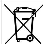
Dieses Symbol befindet sich auf dem Typenschild. Es verweist darauf, dass das Gerät wertvolle Materialien enthält und Sie das Gerät nicht über den Hausmüll entsorgen dürfen. (siehe 1.8 Entsorgung)
