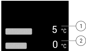
Fig. 6 Status display shows the actual temperature.
