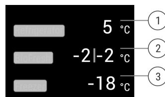
Fig. 8 状态显示器显示实际温度。\*
