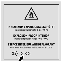
Fig. 3 Schutzklasse: II 3/-G Ex ec IIC T6 Gc/-
