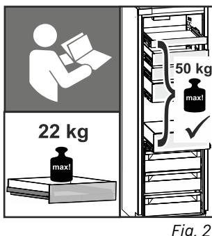
Beladung eines einzelnen Schubfachs beträgt maximal 22 kg.
