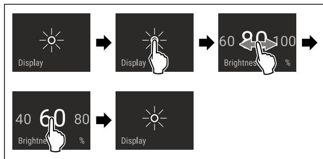
Fig. 50 Beispielhafte Darstellung: Von 80 % zu 60 % wechseln.
