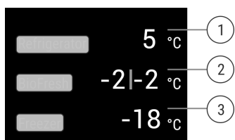
Fig. 8 L'affichage d'état indique la température réelle.*
