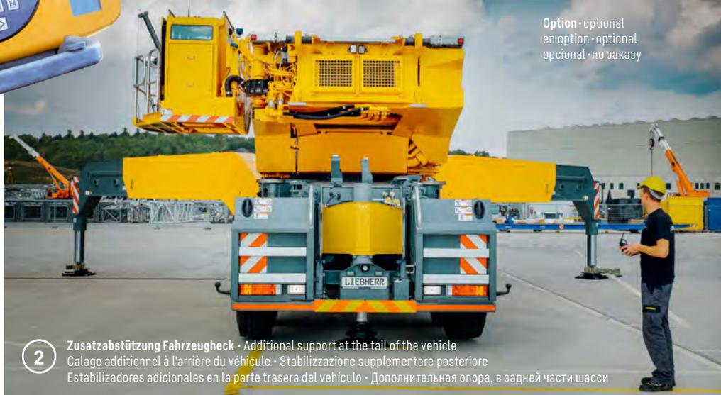
**2 Zusatzabstützung Fahrzeugheck** · Additional support at the tail of the vehicle
