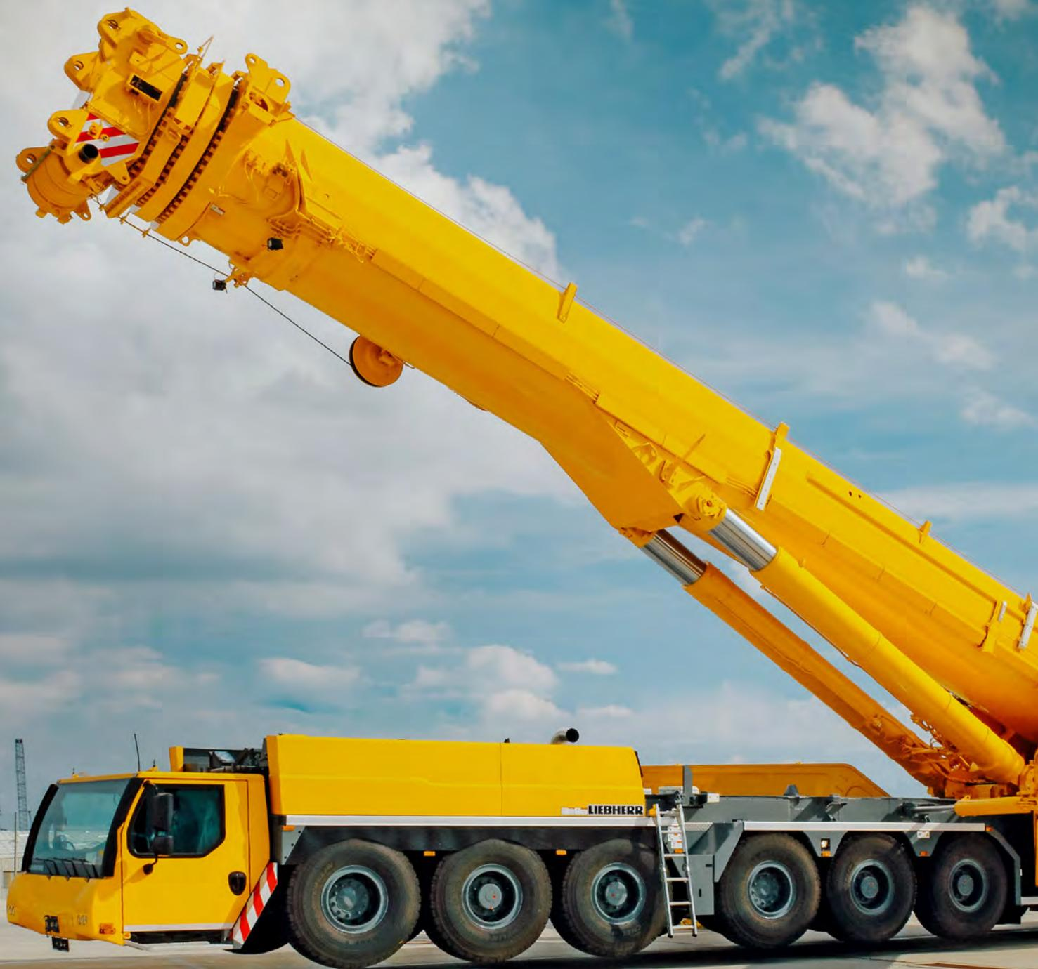
1 Abgestützt auf den vorderen Stützen • Supported on the front outriggers • Calée sur les stabilisateurs avant
