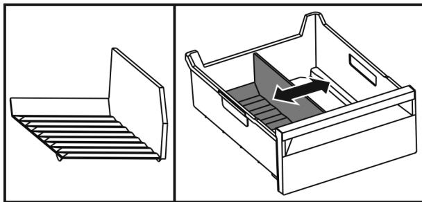
Fig. 115 冰格分隔器示例图
