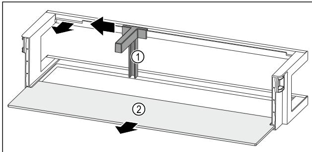
Fig. 92 带瓶托和搁板的门边存放架
