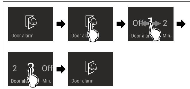
Fig. 53 例图：将门开警报从 1 分钟切换到 3 分钟。
