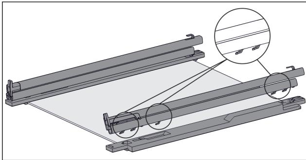
Fig. 128 带轨道和固定件的玻璃隔板
