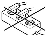
Keine Inselwechselrichter (Umwandeln von Gleichstrom in Wechsel- bzw. Drehstrom) oder Energiesparstecker verwenden. Beschädigungsgefahr für die Elektronik!
