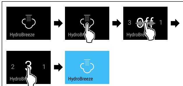
Fig. 52 Beispielhafte Darstellung: HydroBreeze mit Wert 3 aktivieren.
