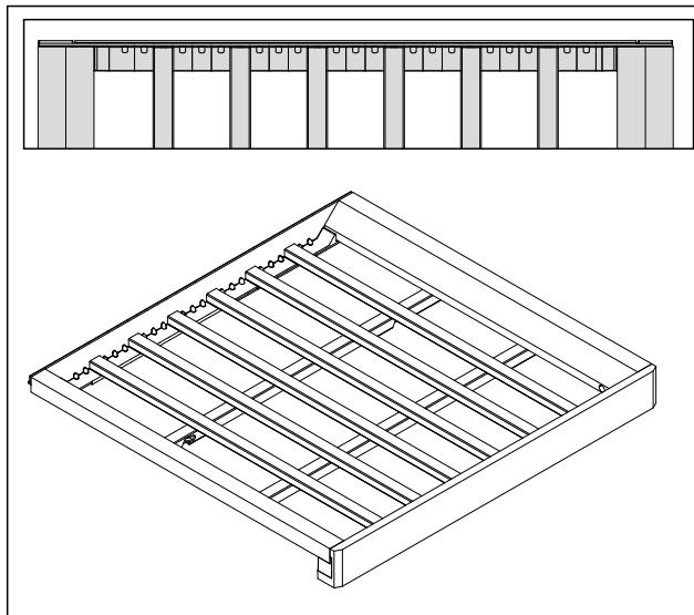
*Fig. 94 Anordnung der Leisten für maximale Flaschenanzahl*
