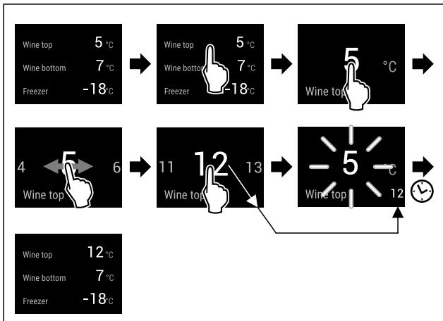
Fig. 21 Beispielhafte Darstellung: Temperatur im oberen Weintteil einstellen.
