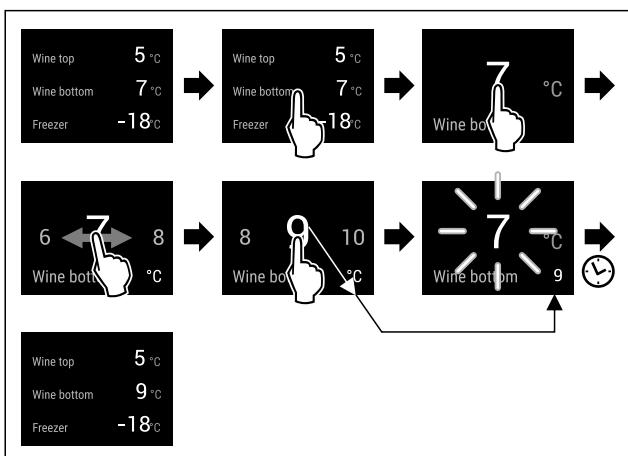
Fig. 22 Beispielhafte Darstellung: Temperatur im unteren Weintteil einstellen.
