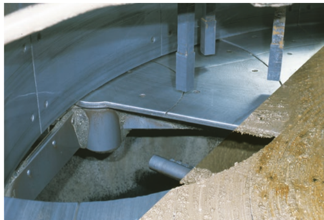
Système de nettoyage haute pression du malaxeur.
