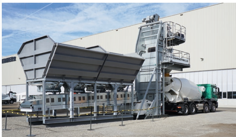
Version trémies en ligne mobile, possibilité de 2 à 8 cases, volume de stockage total de 50 à 150 m 3 .
