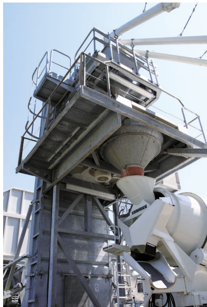
Grand espace libre sous la plate-forme du malaxeur.
