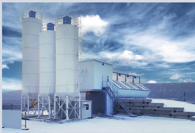
Compactmix 1.0 avec bardage isolé pour l'exploitation hivernale en Russie.
