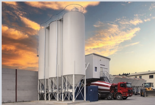
Compactmix 1.0 avec bardage adapté au fonctionnement hivernal.
