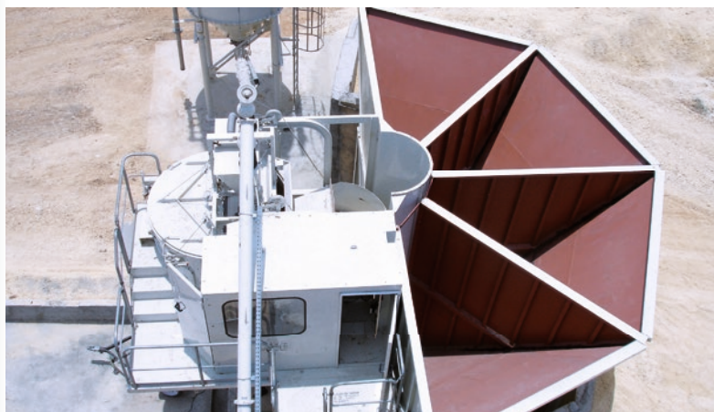
Version silos à poches, 4 cases, pour un volume de stockage total de 40 m 3 .
