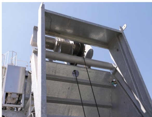
Le chemin de roulement du skip.
