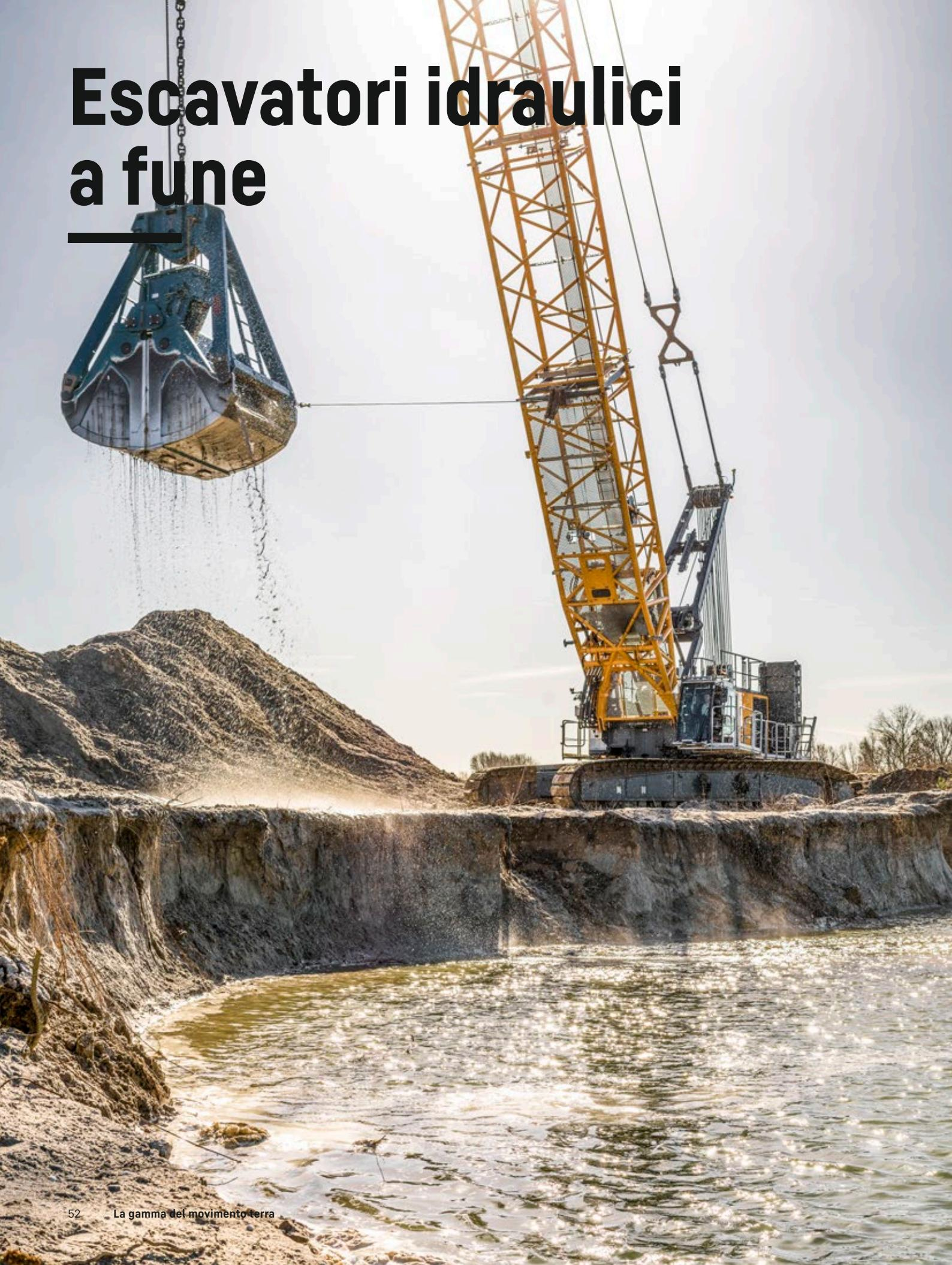
Oltre alla movimentazione dei materiali, all'estrazione della ghiaia e al riciclaggio, gli escavatori idraulici a fune Liebherr sono utilizzati principalmente nei lavori di fondazione speciale. La gamma di modelli comprende unità di tutte le classi di potenza, da 40 a 300 tonnellate. Queste macchine collaudate sono caratterizzate da flessibilità, efficienza e prestazioni eccezionali.
