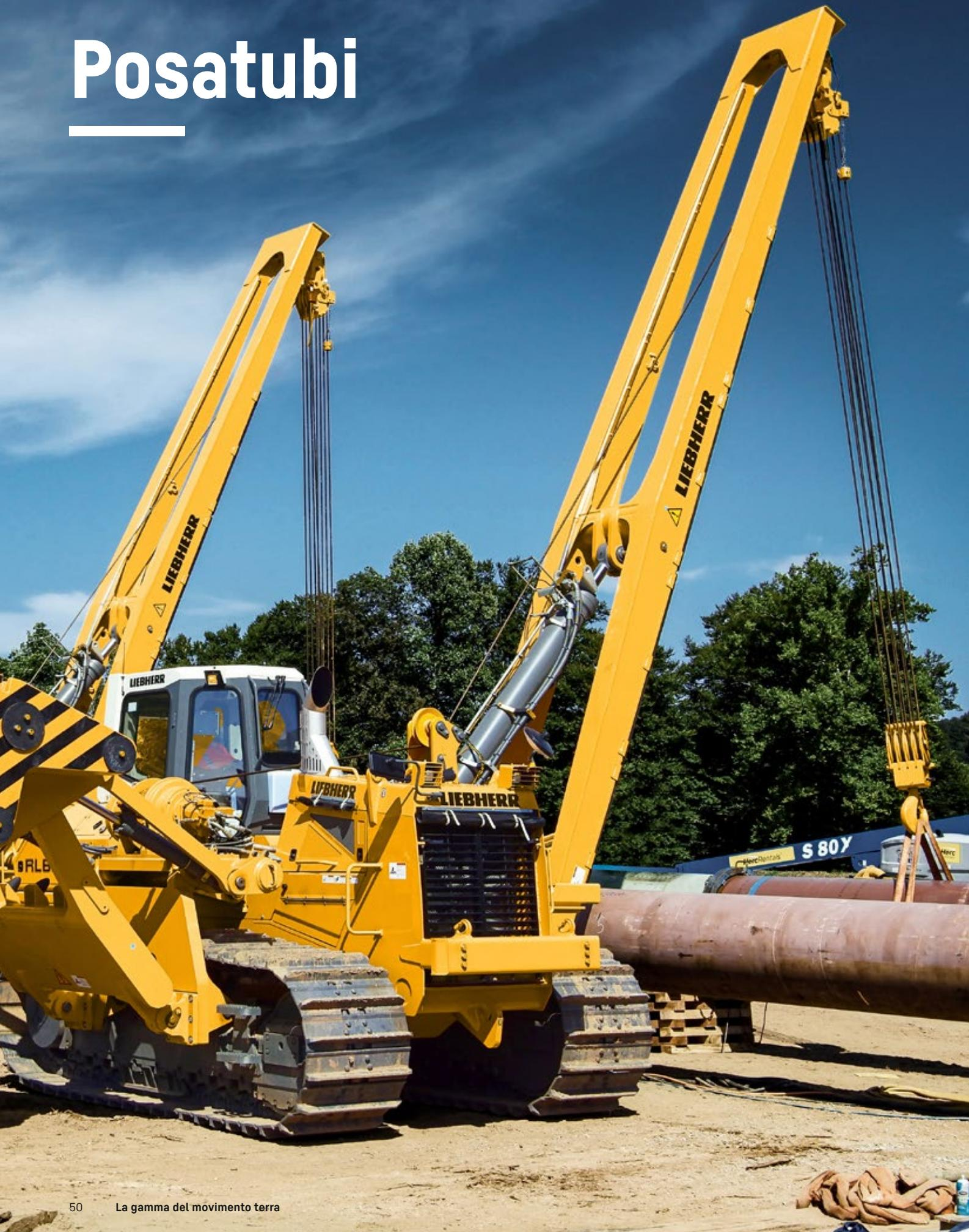
Che si tratti della posa di tubi in pendenza o su terreni soffici: portata elevata, trasmissione idrostatica a regolazione continua, idraulica di lavoro dal controllo preciso e funzioni di sicurezza intelligenti consentono la massima produttività e sicurezza in cantiere.
