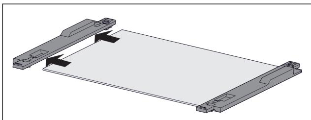
Fig. 129 Glasplatte mit Halteteilen
