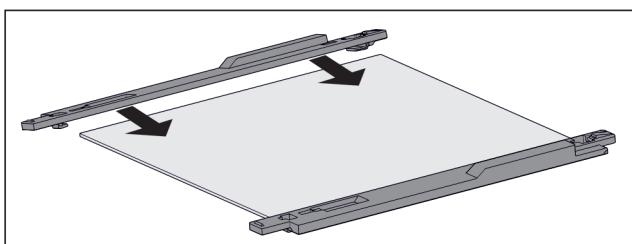
Fig. 130 Glasplatte mit Halteteilen
