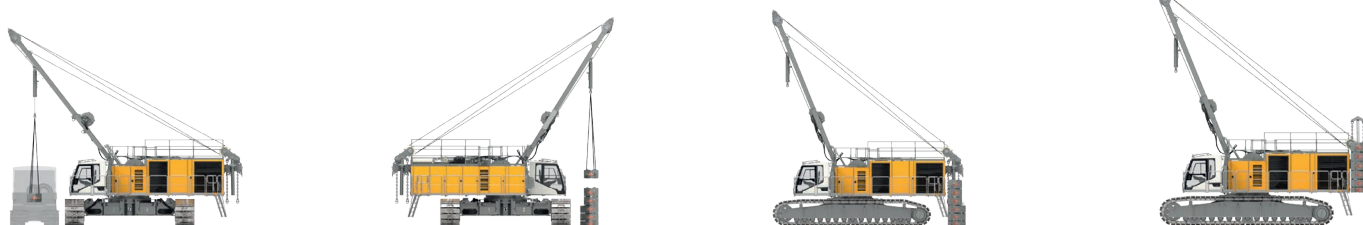
Déchargement, assemblage et montage du contrepoids tourelle
