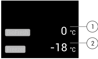
Fig. 6 The status display shows the actual temperature.
