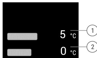
Die Statusanzeige zeigt die Ist-Temperatur und ist die Ausgangsanzeige. Von dort aus erfolgt die Navigation zu den Funktionen und Einstellungen.
