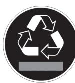
Dieser oder ein ähnlicher Aufkleber kann sich auf der Rückseite des Gerätes befinden. Er verweist darauf, dass sich in der Tür und/oder im Gehäuse Vakuumisolierpaneelle (VIP) oder Perlitpaneelle befinden. Dieser Hinweis ist nur für das Recycling bedeutsam. Den Aufkleber nicht entfernen.
