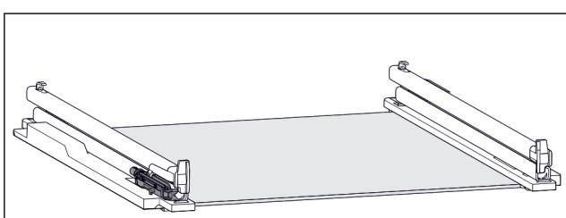
Fig. 131 Dämpfungseinheit
