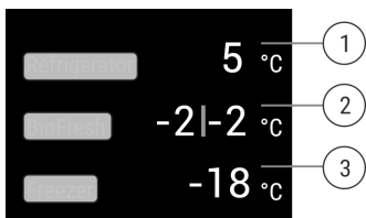
Fig. 8 Statusanzeige zeigt Ist-Temperatur.*
