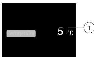
*Fig. 7 Status display shows the actual temperature.*
