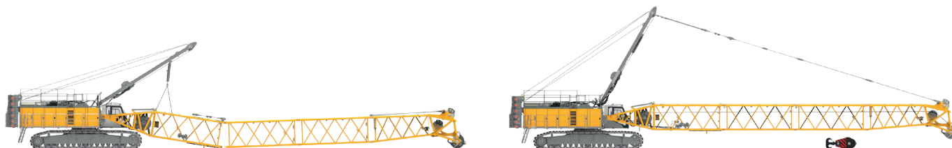
Montaje de la pluma
