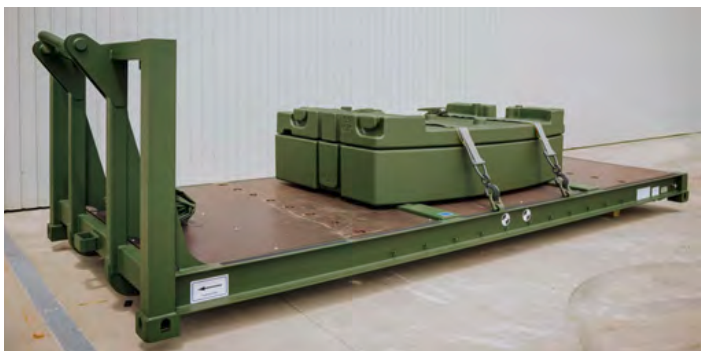
Zusatzballast • Additional ballast • Lest additionnel 14,1 t Gesamtgewicht • Gross weight • Poids total 15,6 t
