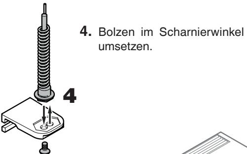
4. Bolzen im Scharnierwinkel umsetzen.
