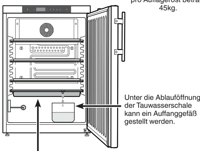
Die Tauwasserschale darf nur in der untersten Auflagerrippe eingeschoben werden.
