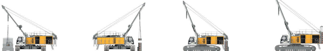
Descarga, montaje y adosamiento del contrapeso trasero
