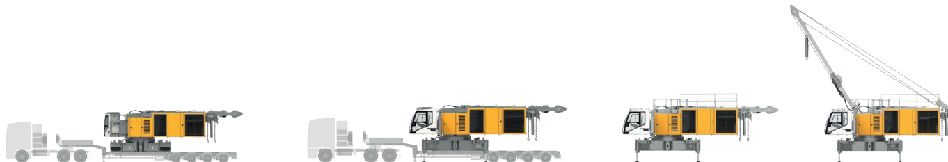
Descarga de la máquina base (opcional)
