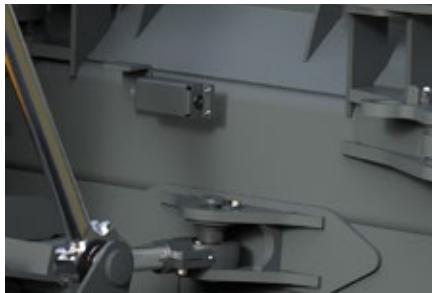
Consoles pour le montage des mâts et supports pour le capteur d'inclinaison transversale.
