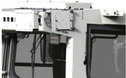
Câble de raccordement et possibilité de montage sur la cabine pour le radio-transmetteur de données pour l'exploitation du GPS/GNSS ou du tachéomètre.
