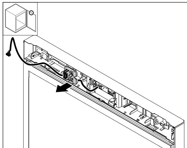
Fig. 29 Die Einbauposition der Steckerhalterung kann um 180° gedreht sein.
