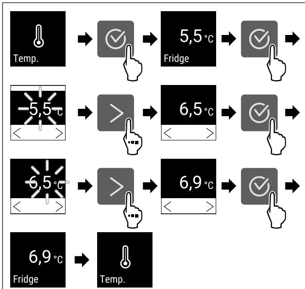
Fig. 74 Temperaturwechsel von 5,5 °C auf 6,9 °C
