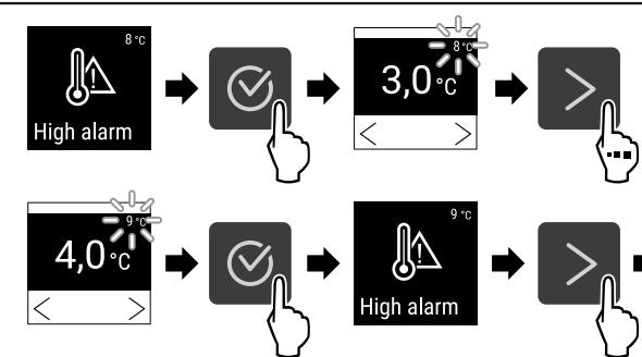
Fig. 141 Beispiel für die Einstellung der Temperaturuntergrenze, basierend auf einer eingestellten Gerätetemperatur von 5 °C.
