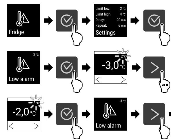
Fig. 140 Beispiel für die Einstellung der Temperaturuntergrenze, basierend auf einer eingestellten Gerätetemperatur von 5 °C.
