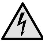
Das Symbol befindet sich auf der Geräterückseite im Bereich des Alarmrelais und weist auf folgende Gefahr hin: **Elektrischer Schlag!** Auch bei einem vom Netz getrennten Gerät kann noch Fremdspannung anliegen. Aufkleber nicht entfernen.
