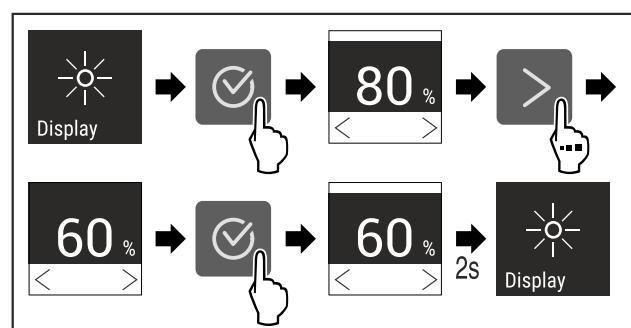
Fig. 99 Beispielhafte Darstellung: Von 80 % zu 60 % wechseln.
