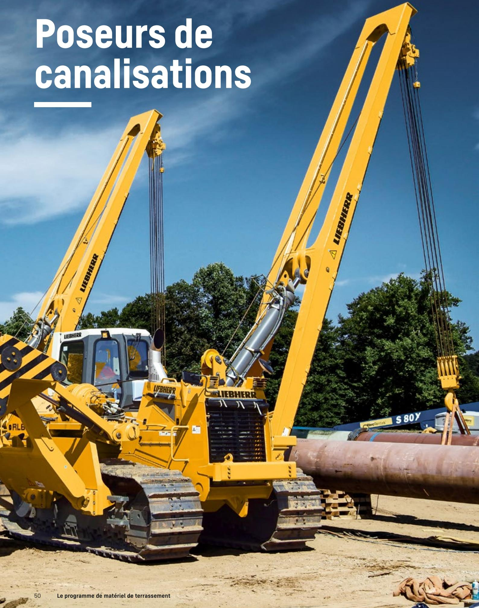
**Que ce soit pour la pose de tuyaux en pente ou sur des sols meubles : la capacité de charge élevée, l'entraînement hydrostatique continu, le circuit hydraulique de travail à commande précise ainsi que les fonctions de sécurité intelligentes offrent une productivité et une sécurité de chantier maximales.**
