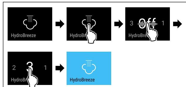
Fig. 56 Beispielhafte Darstellung: HydroBreeze mit Wert 3 aktivieren.
