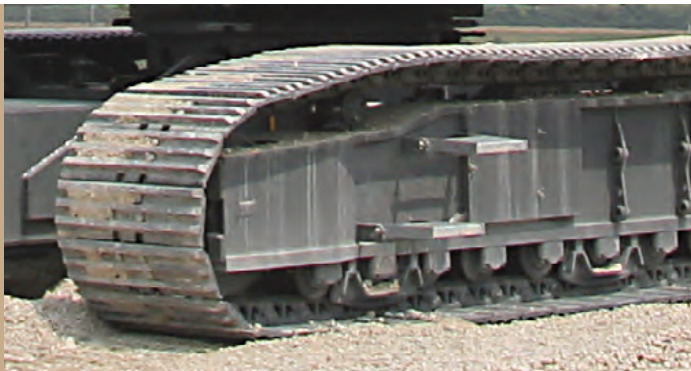
3-Stege-Bodenplatten, Breite 900 mm • triple grouser track pads, Width 900 mm Tuiles à 3 nervures, Largeur 900 mm • 3-file piastre cingoli, Larghezza 900 mm Tejas de 3 perfiles, Anchura 900 mm • 3-рёберные траки, Ширина 900 мм
