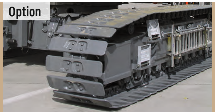
Option Flachbodenplatten, Breite 900 mm • Flat track pads, Width 900 mm Tuiles plates, Largeur 900 mm • Cilindri piatti, Larghezza 900 mm Tejas planas, Anchura 900 mm • Плоские траки, Ширина 900 мм
