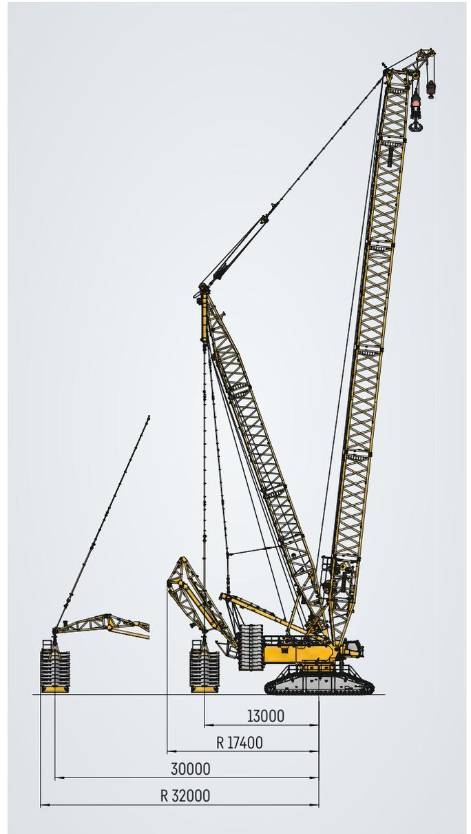
Der V-Frame® bietet maximale Flexibilität mit seinen stufenlos verstellbaren Ballastradien.
