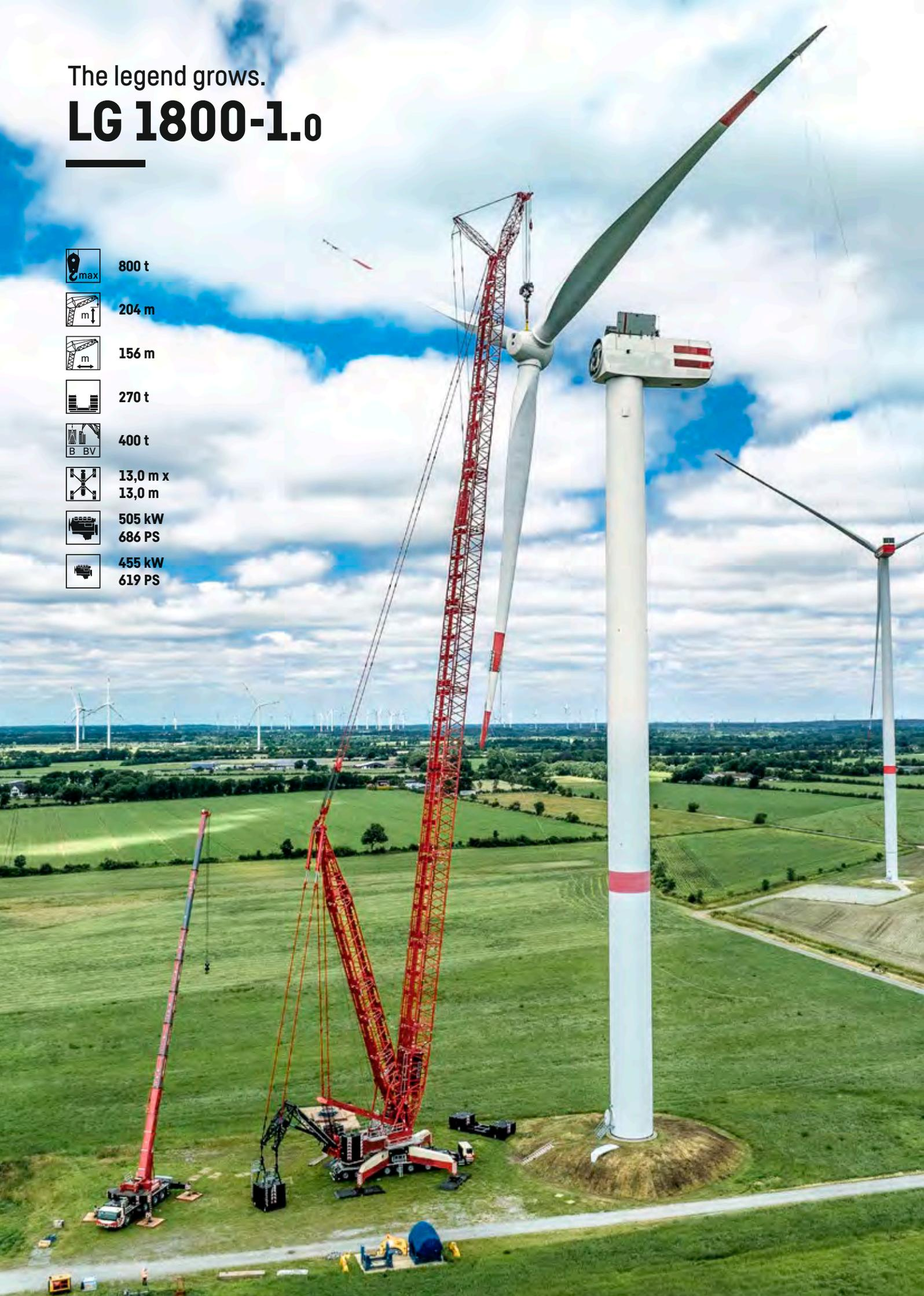
**Der LG 1800-1.0 vereint die Mobilität eines All-Terrain-Kranes mit den hohen Traglasten eines Gittermastkrans. Der LG 1800-1.0 verfügt dazu über modernste Kran-Technologie wie V-Frame®, VarioTray®, das ZF-Getriebe TraXon Torque mit ECOdrive und die WindSpeed Load Charts. Und: Die Ausrüstung des LR 1800-1.0 kann auch auf den LG 1800-1.0 übernommen werden.**
