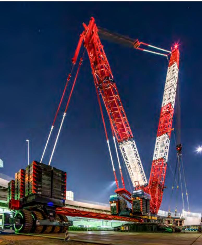
Mit Nutzung eines Ballastwagens kann der Raupenkran auf der Baustelle verfahren werden, während die Last am Haken hängt – ohne das ganze Ballastsystem wechseln zu müssen.
