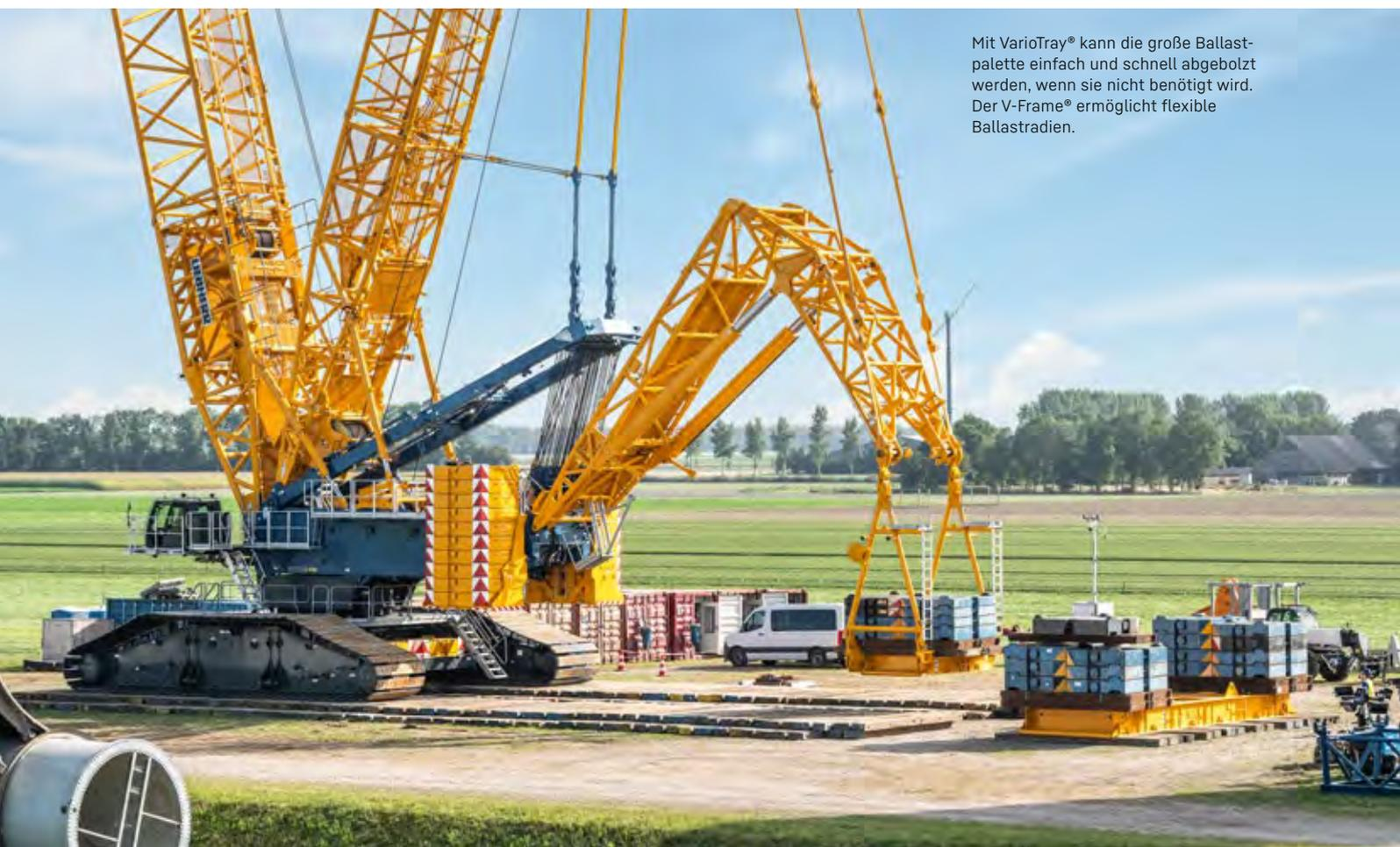
Mit VarioTray® kann die große Ballastpalette einfach und schnell abgezolt werden, wenn sie nicht benötigt wird. Der V-Frame® ermöglicht flexible Ballastradien.
