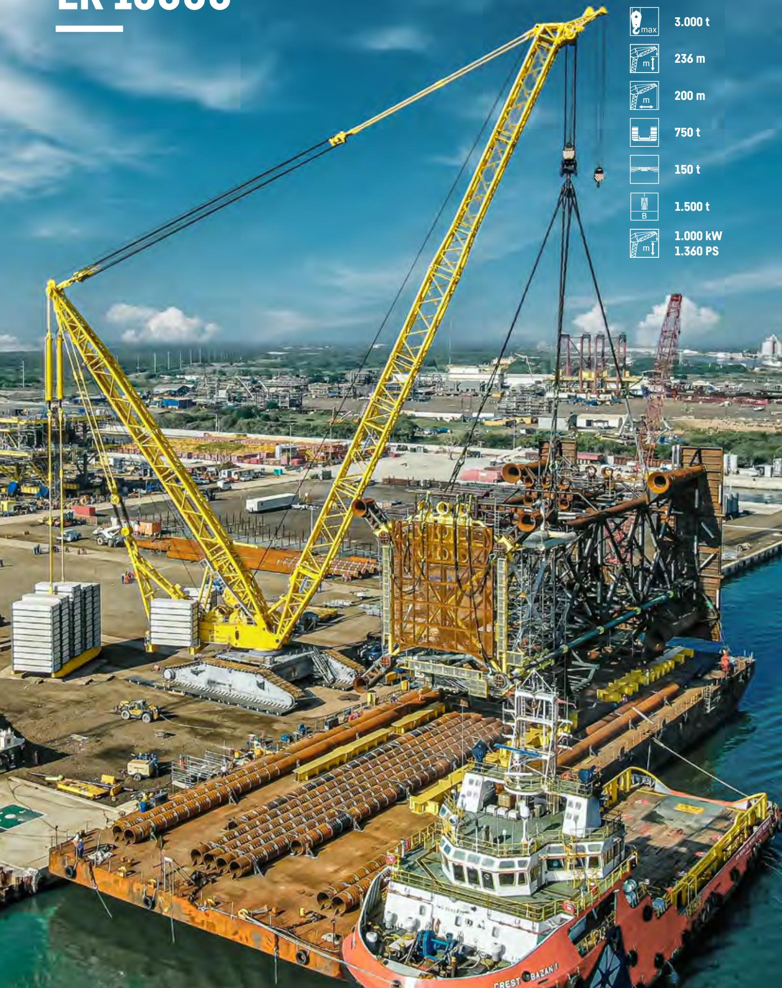
**Der LR 13000 ist der weltweit stärkste Raupenkran konventioneller Bauart. Ein wichtiger Einsatzbereich für ihn ist der Kraftwerksbau. Insbesondere dort wird das Heben extremer Stückgewichte ständig neu gefordert. Auch in Raffinerien bestehen die Anforderungen, Industrie-Kolonnen mit 1.500 Tonnen Gewicht und 100 Meter Länge aufzustellen. Und: Mit Einzelgewichten von maximal 70 Tonnen ist dieser gigantische Kran trotz seiner Größe weltweit wirtschaftlich transportabel.**
