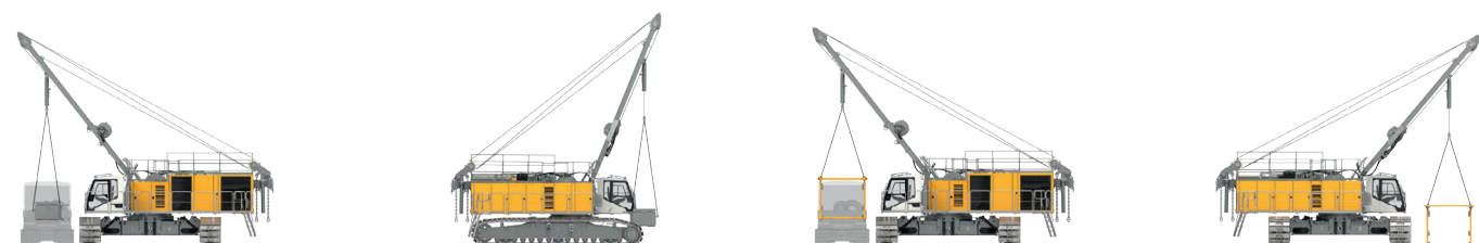
Déchargement et montage du contrepoids central
