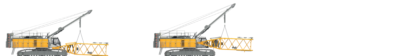
Montage du pied de flèche
