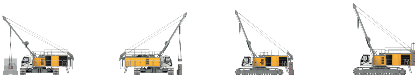
Déchargement, assemblage et montage du contrepoids tourelle
