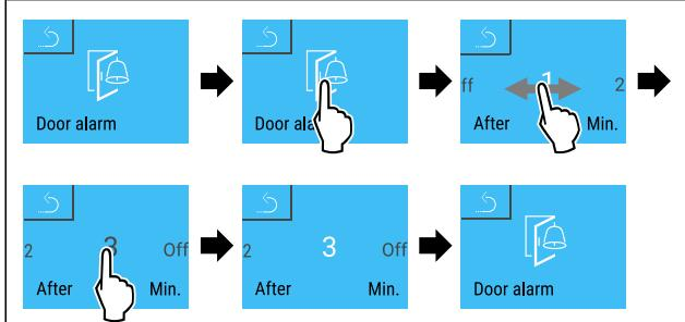
Fig. 80 例图：将门开警报从 1 分钟切换到 3 分钟。
