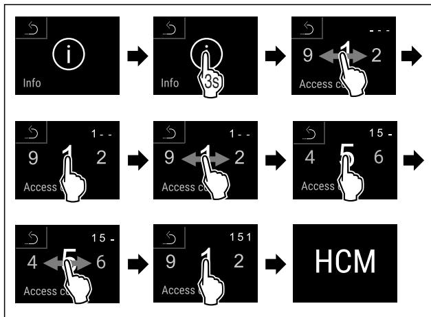
Fig. 4 例图，使用数字代码 151 访问
