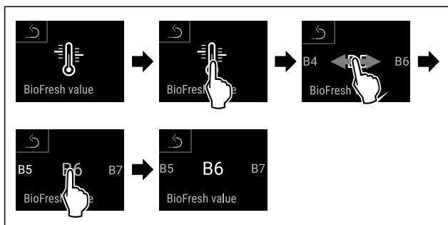
Fig. 25 例图：从 B5 切换到 B6。
