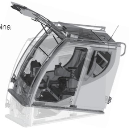
Cabina inclinable: se puede inclinar 20° hacia atrás
