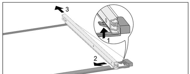
Fig. 118 Glasplatte mit Schienen
