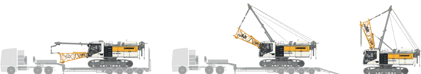
Déchargement de la pelle de base (standard)
