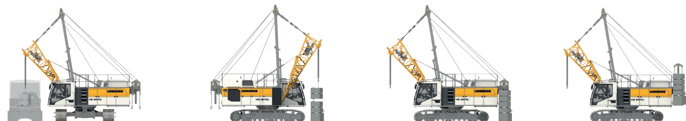
Déchargement, assemblage et montage du contrepoids tourelle
