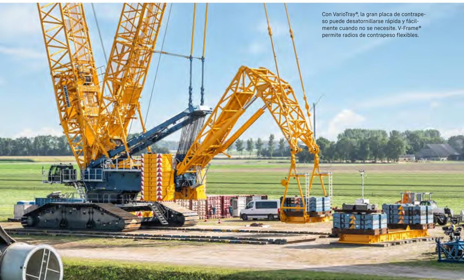
Con VarioTray®, la gran placa de contrapeso puede desatornillarse rápida y fácilmente cuando no se necesite. V-Frame® permite radios de contrapeso flexibles.
