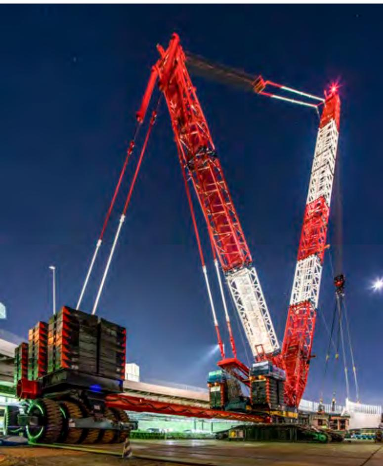
Si se usa un carro de contrapeso, puede desplazarse la grúa sobre orugas en la obra mientras la carga cuelga del gancho, sin necesidad de cambiar todo el sistema de contrapeso.
