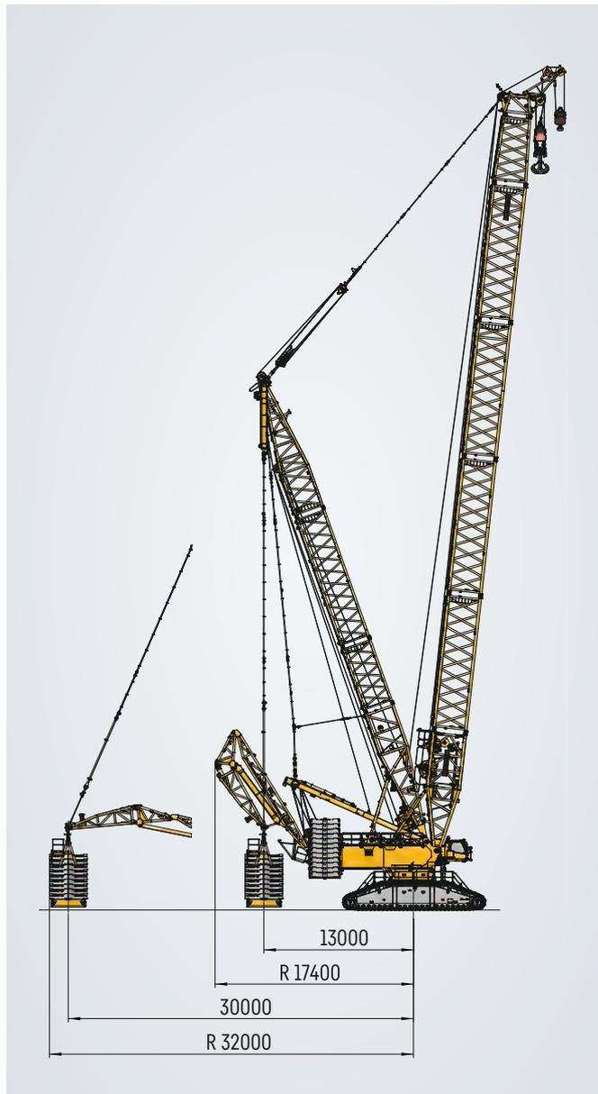
El bastidor V-Frame® ofrece la máxima flexibilidad con sus radios de contrapeso infinitamente ajustables.
