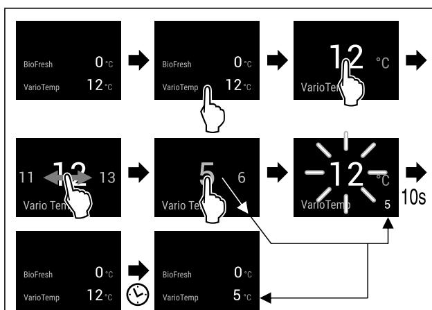
Fig. 28 Beispielhafte Darstellung: VarioTemp von 12 °C auf 5 °C für eine BioFresh-Gefriert-Kombination ändern.
