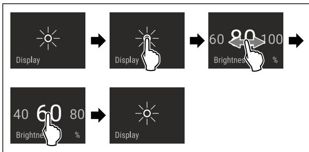
Fig. 76 Beispielhafte Darstellung: Von 80 % zu 60 % wechseln.
