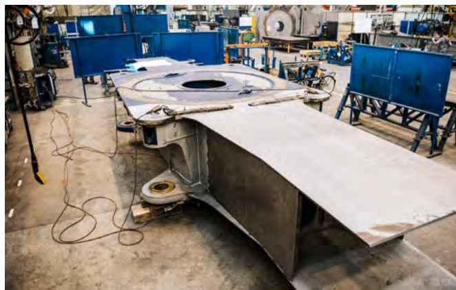
Réparation d'une partie d'un châssis suite à un accident
