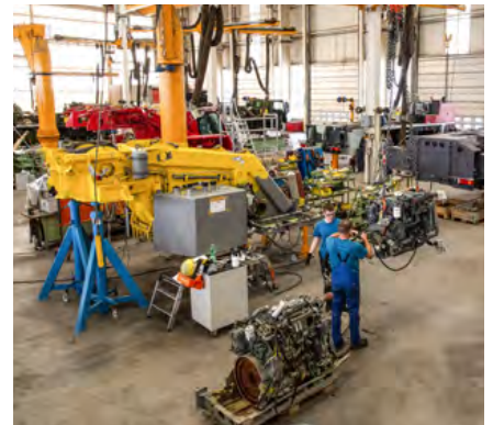
Remplacement du moteur de la tourelle et remise en état
