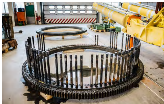
Contrôle de la couronne d'orientation suivie d'une rénovation
