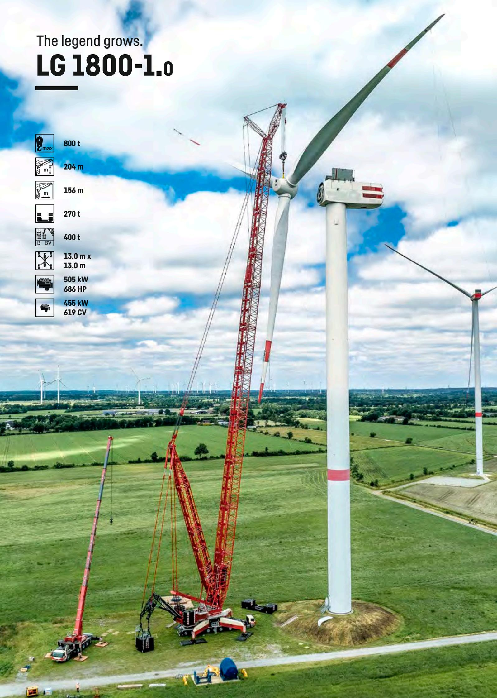
L'LG 1800-1.0 combina la mobilità di una gru All-Terrain con le elevate capacità di carico di una gru cingolata. L'LG 1800-1.0 è inoltre dotata di tecnologie all'avanguardia, come V-Frame®, VarioTray®, la trasmissione ZF TraXon Torque con ECOdrive e le WindSpeed Load Charts. Inoltre, l'equipaggiamento dell'LR 1800-1.0 può essere trasferito anche all'LG 1800-1.0.
