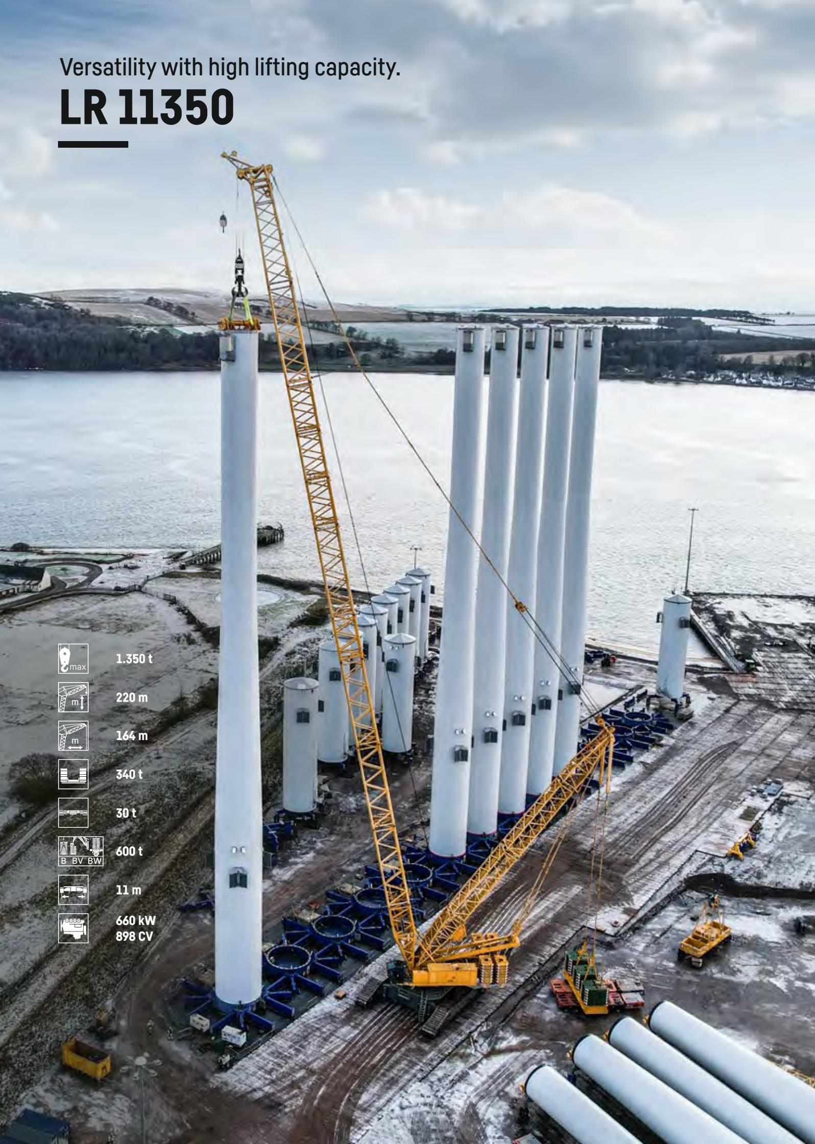
**L'LR 11350 viene utilizzata con capacità di carico eccezionali in tutta la gamma di lavoro. Questa gru può essere utilizzata universalmente, soprattutto nella movimentazione offshore, in quanto è in grado di gestire elevati pesi unitari con e senza PowerBoom. Inoltre, raggiunge l'enorme altezza del gancio di 220 metri.**
