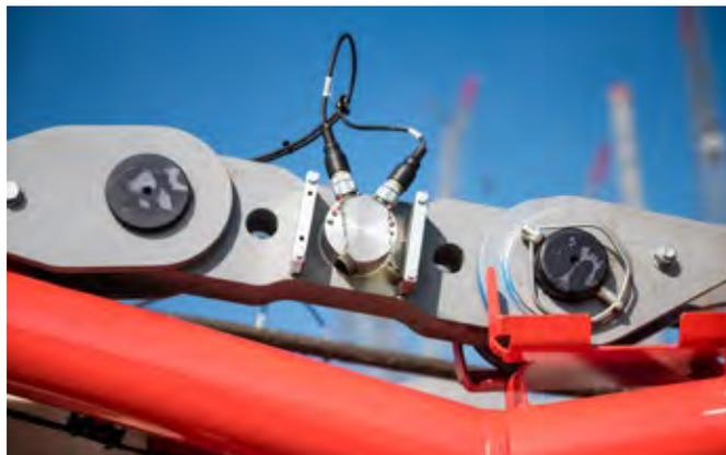
Il capocorda di misurazione della tensione è progettato con due canali (2 spine)
