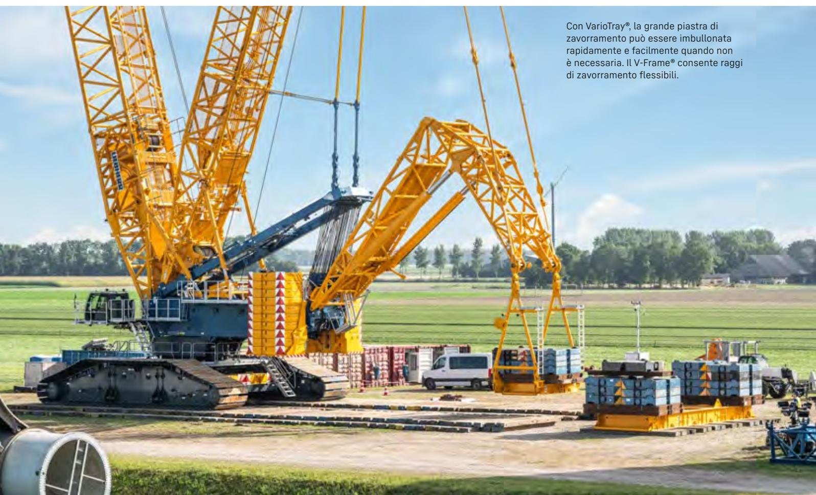
Con VarioTray®, la grande piastra di zavorramento può essere imbullonata rapidamente e facilmente quando non è necessaria. Il V-Frame® consente raggi di zavorramento flessibili.
