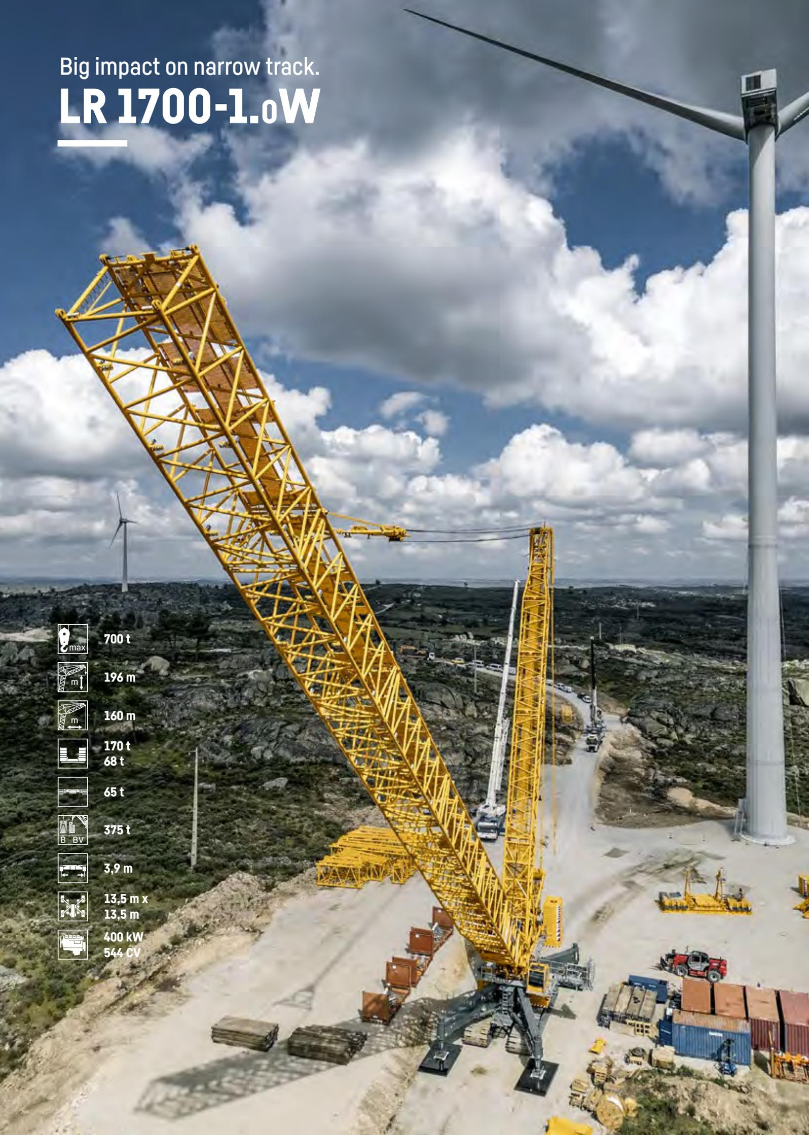
**Ingombro ridotto con elevata capacità di carico: l'LR 1700-1.0W è ideale per l'installazione efficiente delle moderne turbine eoliche nei parchi eolici. La gru cingolata a scartamento ridotto è dotata delle più moderne tecnologie per gru cingolate, come il telaio Heavy-Duty, la guida di zavorramento V-Frame® e il sistema di zavorramento divisibile VarioTray®.**
