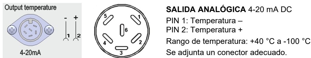
Figura 20: Configuración del pin del conector (10) para la opción salida analógica
