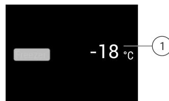
Fig. 6 Status display shows the actual temperature.
