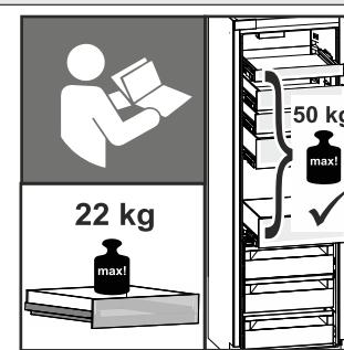
Beladung eines einzelnen Schubfachs beträgt maximal 22 kg.
