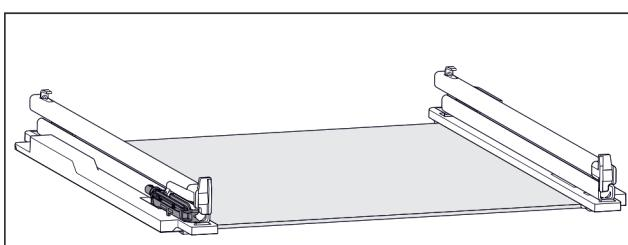
Fig. 132 Dämpfungseinheit
