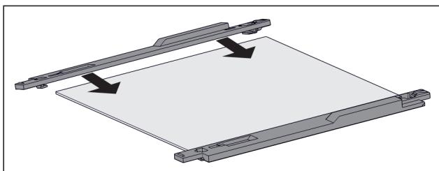
Fig. 131 Glasplatte mit Halteteilen
