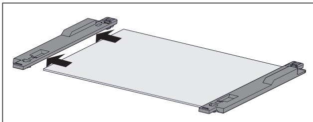
Fig. 130 Glasplatte mit Halteteilen
