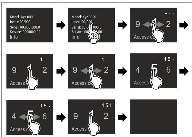
Fig. 4 Beispielhafte Darstellung, Zugang mit Zahlenkode
