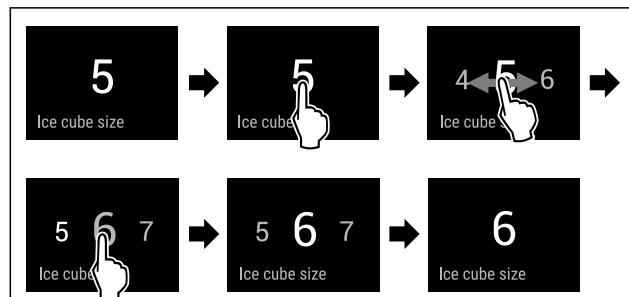
Fig. 51 Beispielhafte Darstellung: Von Wert 5 zu Wert 6 wechseln.
