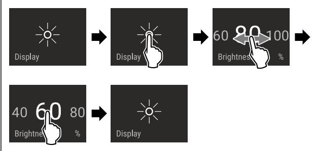
Fig. 56 Beispielhafte Darstellung: Von 80 % zu 60 % wechseln.
