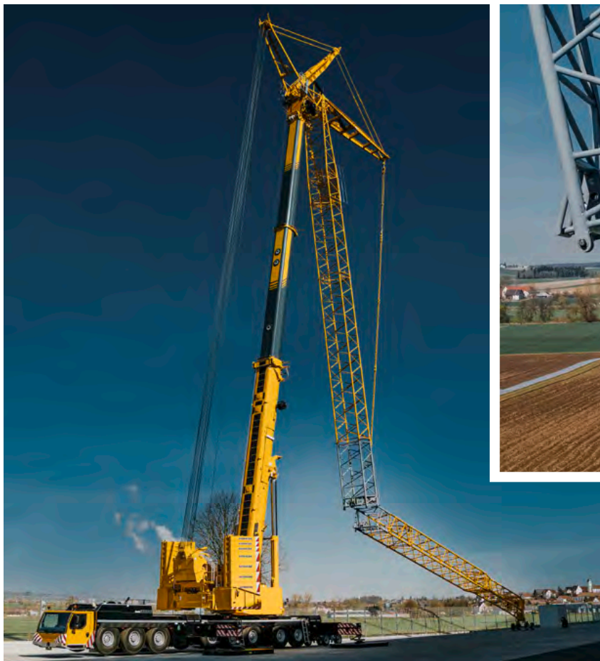
NK-Zwischenstück mit Klapp-Mechanismus • NK intermediate section with folding mechanism • Pièce de jonction NK avec mécanisme rabattable • Sezione intermedia NK con meccanismo di ripiegamento • Pieza intermedia NK con mecanismo abatible • Промежуточная деталь NK со складным механизмом
