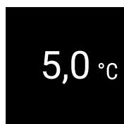
Fig. 178 Affichage d'état avec température réelle
