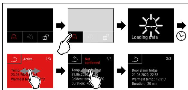
*Fig. 260 Данный пример описывает активный аварийный сигнал, неподтвержденный аварийный сигнал и подтвержденный аварийный сигнал.*
