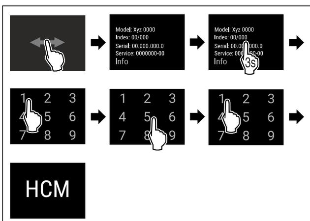
Fig. 8 Доступ при помощи числового кода **151**
