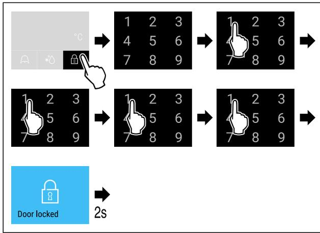
Fig. 107 Блокировка двери при помощи кода двери 1 1 1 1.
