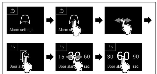
Fig. 216 Примерное изображение: переключение значения для сигнала открытой двери с 30 секунд на 60 секунд.
