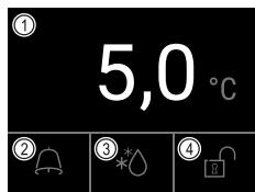
Fig. 86 Индикация состояния
