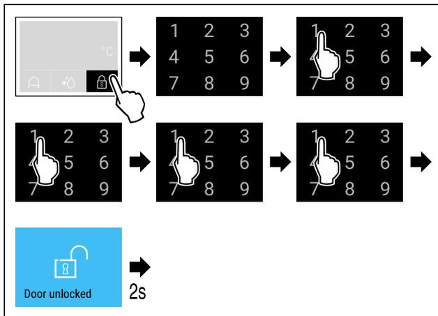
Fig. 110 Разблокировка двери при помощи кода двери 1 1 1 1.
